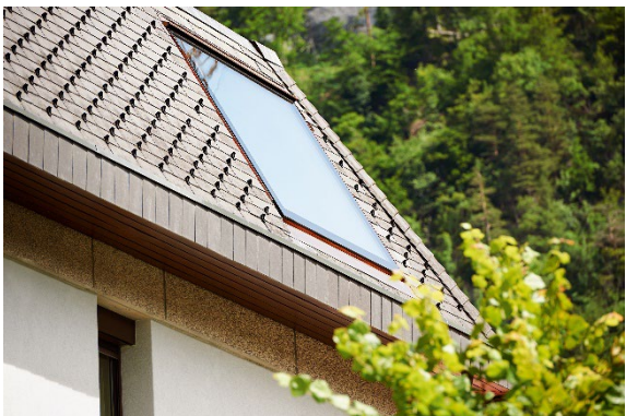
Nahtlos und dezent integriert sich das grossflächige Dachfenster s: 211 in die Gebäudehülle. Es kommt ohne vorstehenden Rahmen oder Aufbauten aus, lediglich ein schmaler Aluminiumrahmen trägt die Scheibe innen. Ziegel oder Dachpfannen überdecken den Markisenkasten der Beschattung vollflächig.
